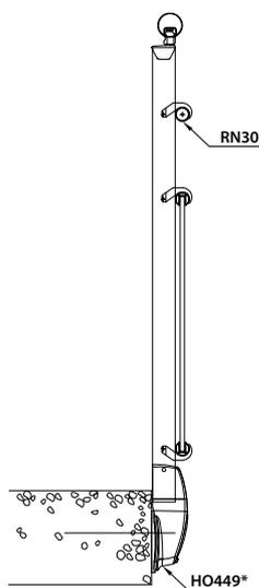
Version vide sous main courante avec une lisse intermédiaire. Fixation en nez de dalle. Barreau support extrudé avec sabot moulé à une fixation.
