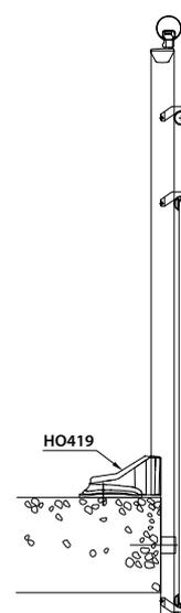
Version vide sous main courante avec une lisse intermédiaire. Version passant devant dalle. Barreau support extrudé avec sabot moulé sur dalle à une fixation.
