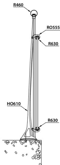
Version vide sous main courante. Fixation sur dalle. Barreau support en aluminium moulé à une fixation.
