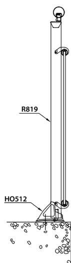
Version vide sous main courante. Fixation sur dalle. Barreau support extrudé avec sabot moulé à une fixation.
