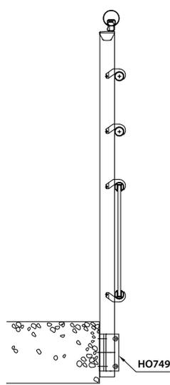
Version vide sous main courante avec deux lisses intermédiaires. Fixation en nez de dalle. Barreau support extrudé avec sabot à deux fixations.
