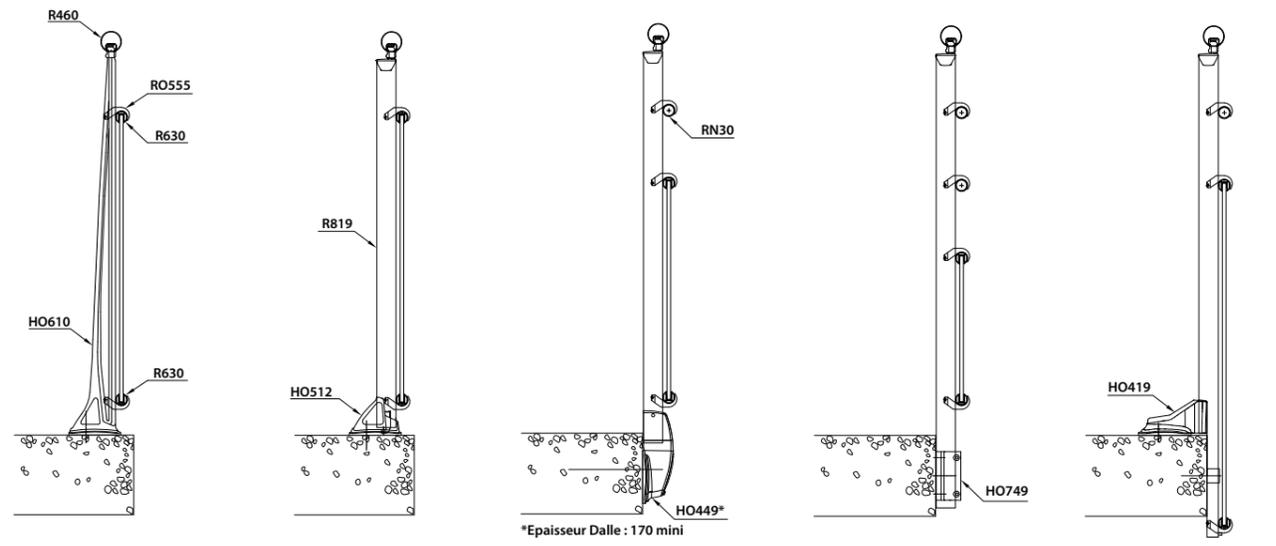
Version vide sous main courante. Fixation sur dalle. Barreau support en aluminium moulé à une fixation.
