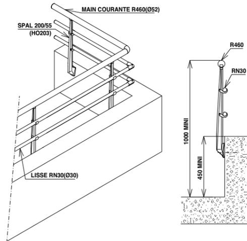
Triple lisses rondes sur barre support moulé fixé contre muret.
