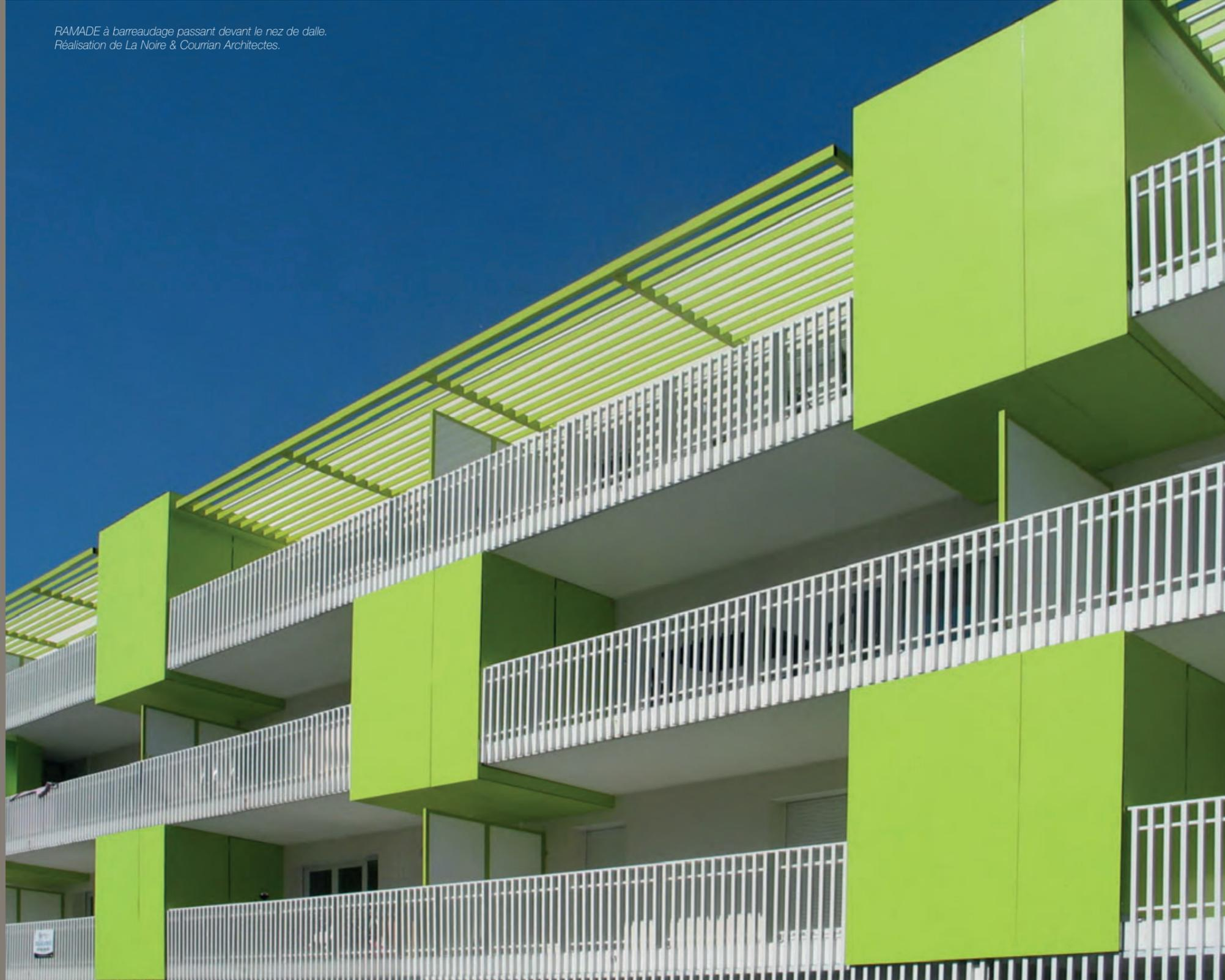
Ce modèle propose un barreaudage aluminium carré (40 x 40) à entraxe fixe ou variable. Main courante en partie haute en arrière plan.
