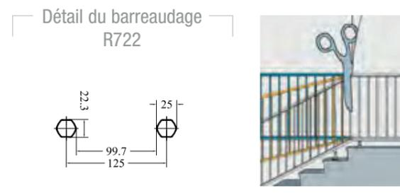
Échelle prémontée de longueurs standard de 2, 4 ou 6 m. À couper à la longueur souhaitée. Inclinaison de 0° à 45°
